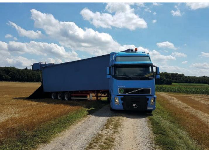
Für den Transport von Kompost und Rübenschneitzeln nutzt der Betrieb u. a. eine Sattelzugmaschine mit Schubbodenauflieger. Während des Winters wird der Sattelschlepper auch für den Winterdienst auf Kantonsstrassen eingesetzt.
