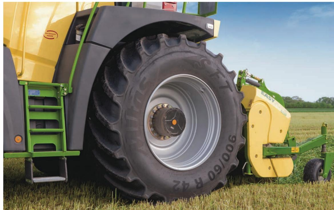
*Mit grossvolumigen Reifen, eventuell ausgestattet mit einer Reifendruckregelanlage, bleibt die Bodenbelastung beim Feldhäcksler auf einem vertretbaren Niveau.*
