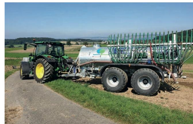
Das Pumpfass mit Schleppschlauchverteiler zahlte sich aus. Jährlich werden zwischen 600 und 700 Fass ausgebracht und die Nachfrage ist stetig steigend.
