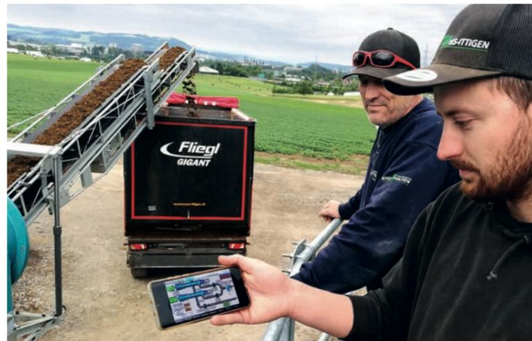
Alle Komponenten der Anlage werden elektrisch angetrieben. Den Strom dazu liefert ein dieselbetriebenes Stromaggregat mit einer Leistung von 160 kW, welches fest auf dem Auflieger verbaut ist. Damit funktioniert die Anlage völlig autark und kann sehr einfach auf wechselnden Standorten betrieben werden. Praktische Ausrüstungen, wie z. B. ein Frischwasserbehälter, ein Hochdruckreiniger und ein Lichtmast vereinfachen dies zusätzlich.
