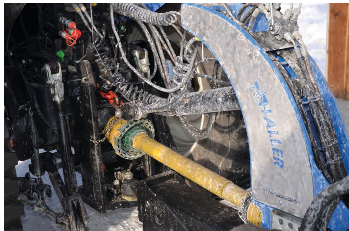
Mittels Topzylinder kann beim Containeraufzug das ganze Traktorgewicht und nicht nur die Hinterachslast eingesetzt werden.
