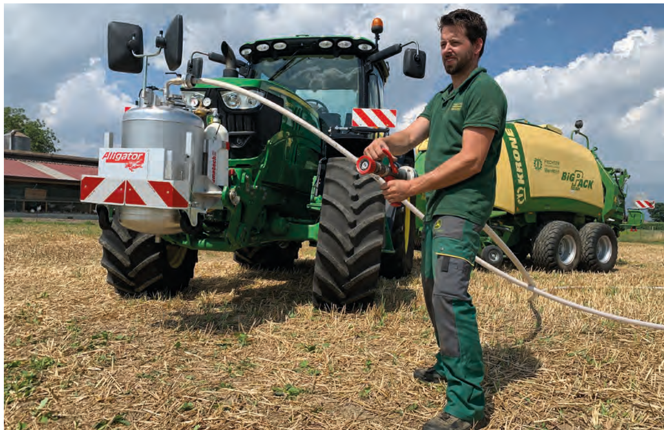
Mobile Löschsysteme wie der Alligator 130 erlauben eine rasche Brandbekämpfung im Feld.
