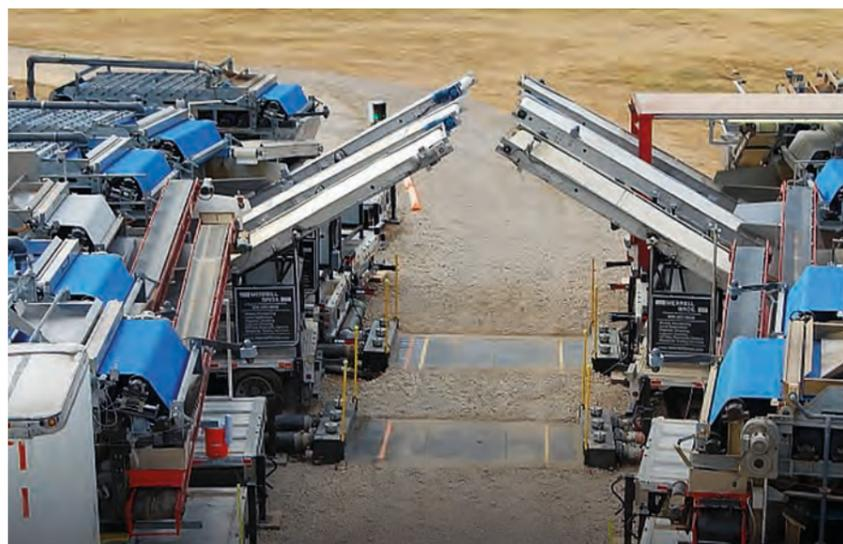
Eine ganze Flotte von selbst entwickelten Separatoren bereitet das Abwasser auf und sortiert die Feststoffe aus.
