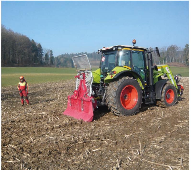
Traktoren müssen mit einer Sicherheitskabine ausgerüstet sein. Die Seilwinde benötigt ein Heckschutzgitter oder eine Heckschutzscheibe aus Sicherheits-glas und die Bedienung muss über eine «Totmannschaltung» mit Notstopp erfolgen. Mit der Funkbedienung kann die Seilwinde von einem sicheren Standort aus betätigt werden.
