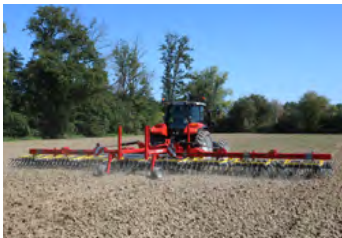
Einfache Einstellungsmöglichkeiten beim Striegel Tinicare V 12200. Den Druck der Doppelfedern von 500 bis 5000 kg ist zentral hydraulisch verstellbar.
