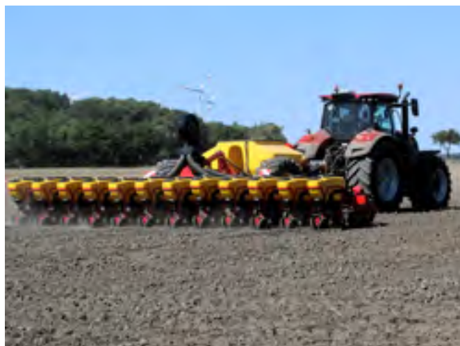
Mit Flüssigdüngersystem als weitere Option: Die bewährte Einzelkornsämaschine Tempo L mit 8 bis 24 Reihen kann auch flüssigen Dünger exakt platzieren.
