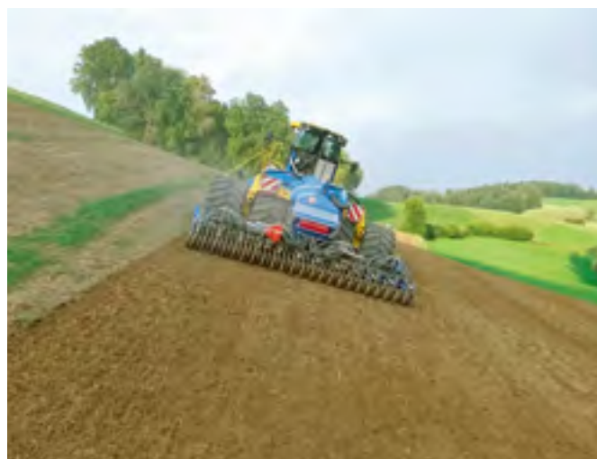
Die bodenschonende Arbeit in Hanglagen ohne wesentliche Abdrift garantiert mit der Rückverfestigung einen gleichmässigen Auflauf und verhindert die Humusabschwemmung.
