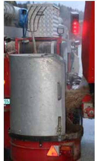
Der Auswurf des Schüttgutes aus dem Dosiergerätes erfolgt direkt auf den Einzug ins Gebläse.
