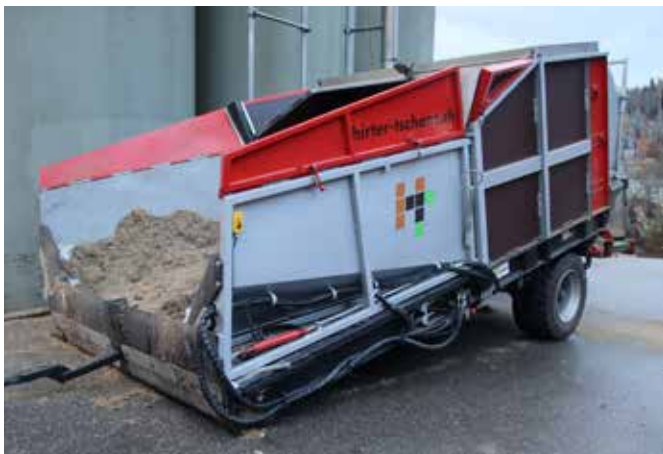
Die Kombination von Dosiergerät und Gebläse ist strassentauglich, und der Dieselmotor auf dem Gebläse ermöglicht bezüglich der Energieversorgung einen völlig autonomen Betrieb.
