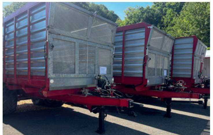
Aus der Maschinenausstattung: Häcksel- und Dosierwagen mit einem Volumen von 22 m<sup>3</sup>.
