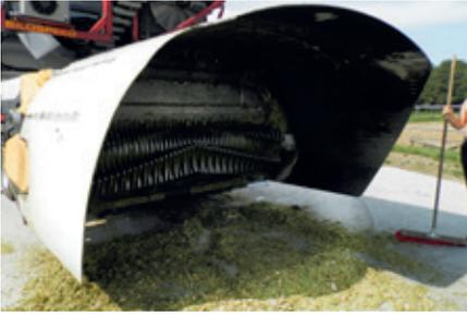
Der Pressrotor und der Metalltunnel verdichten das Material. Somit bilden sich eher senkrechte als waagerechte Schichten.
