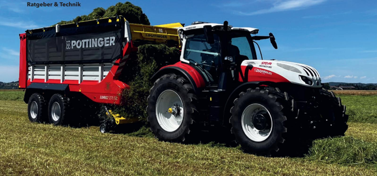
Der Jumbo 5000 hat wie seine grossen Brüder eine bewegliche Frontwand, die bei gleicher Länge für ein Mehrvolumen von 4,3 m<sup>3</sup> sorgt.
