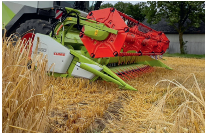
Im Schneidwerk eines Mähdreschers arbeiten Verschleissteile, die während der kurzen Erntezeit enorm beansprucht werden. Deshalb müssen sie regelmässig ersetzt werden.
