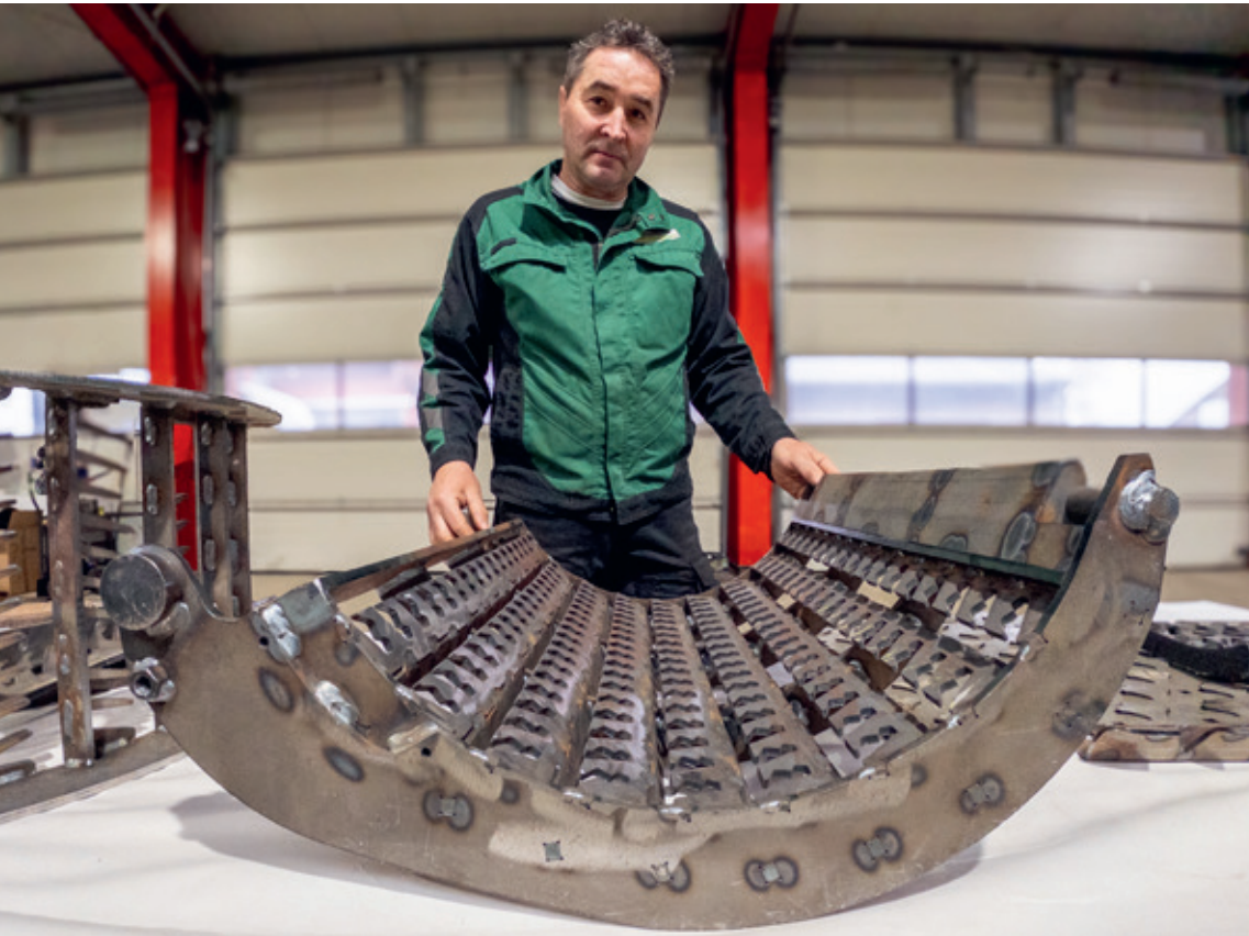
Daniel Kressibucher ist Gründer und Geschäftsführer der Agrar Verschleiss-technik AG. Das Unternehmen entwickelt hochwertige Verschleiss-teile für Landmaschinen und Mähdrescher wie diesen Dreschkorb.
