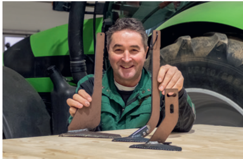
Daniel Kressibucher mit Hackscharen, die einen Wellenschliff aus Hartmetallstählen haben
