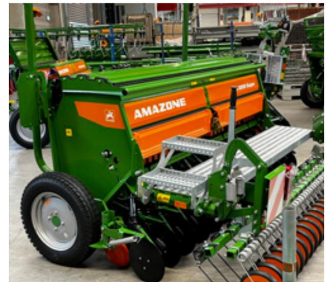
Wer kennt sie nicht? Die Aufbausämaschine AD 3000 mit einer Arbeitsbreite von 3 m.
