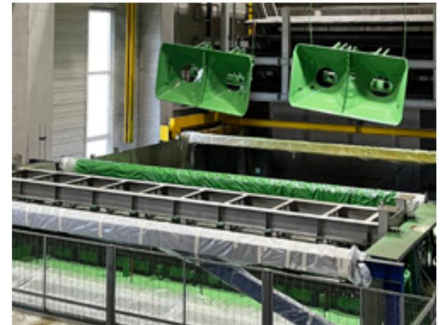
Die Teile werden in einem elektrisch leitfähigen, wässrigen Tauchlack versenkt. Das garantiert eine gleichmässige Beschichtung ohne Läufer.
