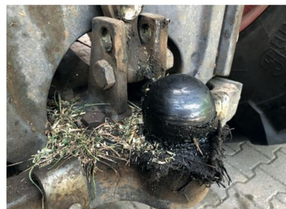
Lors de l'attelage d'une remorque, l'hygiène est nécessaire ! Pour éviter l'usure, toutes les pièces de l'accouplement à boule doivent être soigneusement nettoyées de saleté et de la graisse.
