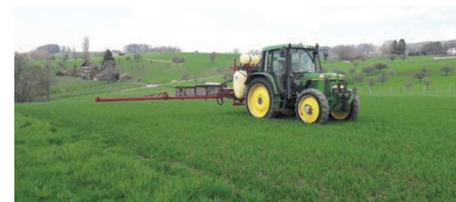
La protection phytosanitaire est également en constante augmentation dans la clientèle de Res Hauser. Pour un travail plus précis dans les cultures existantes, il utilise un système de guidage de voie d'une précision de 20 centimètres.
