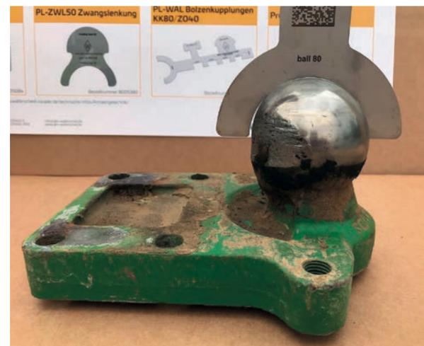
Grâce aux outils spéciaux, l'état d'usure des dispositifs d'attelage peut être clairement déterminé.
