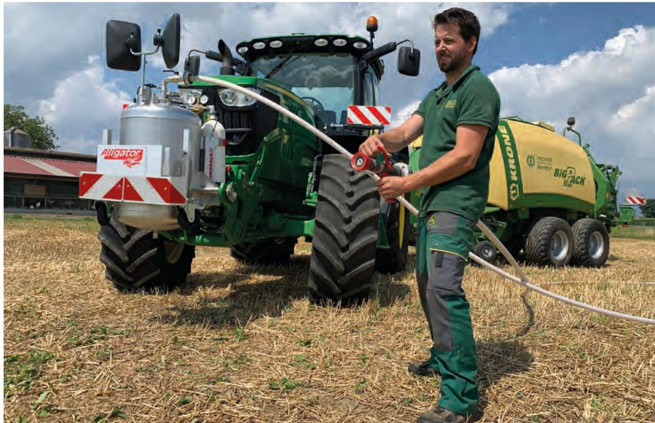
Les systèmes d'extinction mobiles, tels que l'Alligator 130, permettent de lutter rapidement contre les incendies dans les champs.
