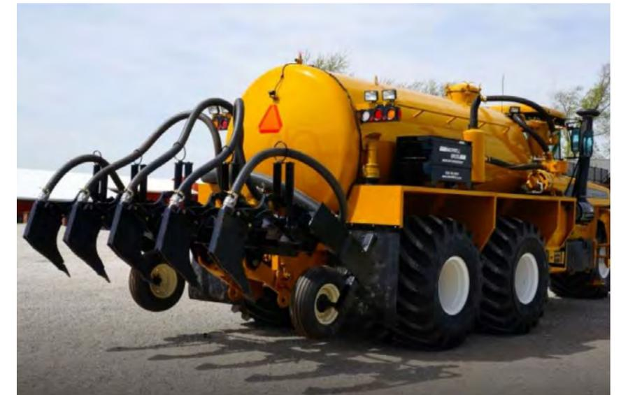
Technique relativement simple pour entailler le lisier et les boues d'épuration.
