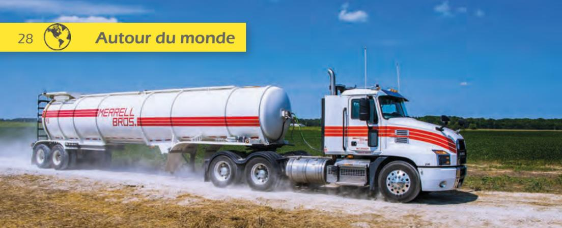
Les citernes sur semi-remorque d'une capacité de 25 m<sup>3</sup> sont utilisées pour transporter le lisier et les boues d'épuration.
