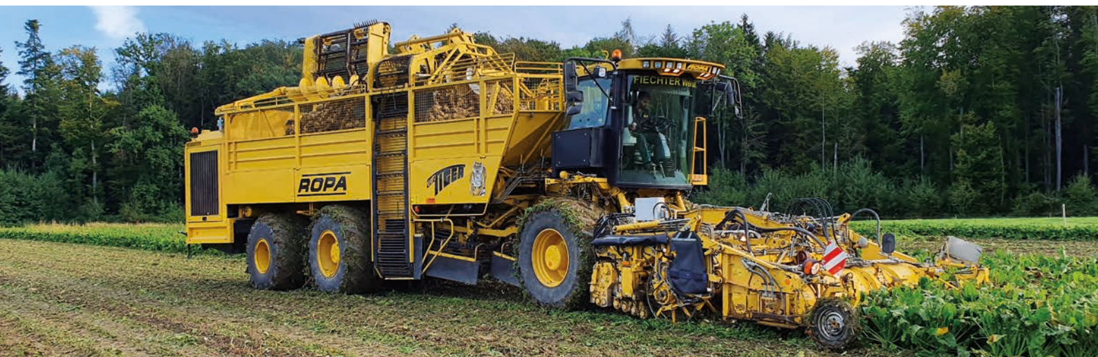
En fin de saison, les deux récolteuses intégrales de betteraves à six rangs de marque Tiger sont mobilisées en permanence.
