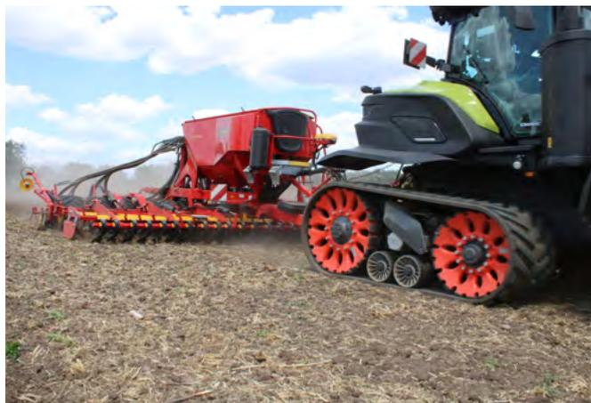
Le Spirit 600S de Väderstad est équipé d'un système de pression de soc hydraulique actif pour une profondeur de dépôt précise.
