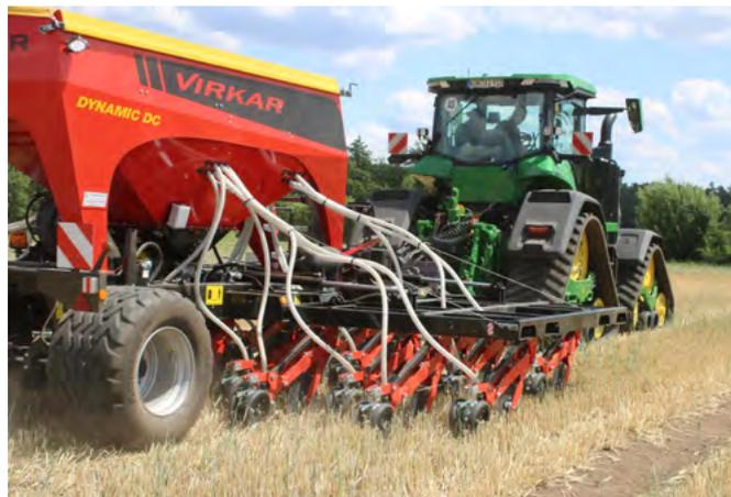
Le semoir direct Dynamic D de Virkar est équipé d'un essieu directeur à l'arrière. Il décharge les bras de soc dans les virages, ce qui réduit la charge sur les composants.
