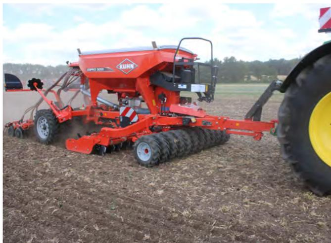
Espro: les roues décalés du rouleau packer sont conçues pour empêcher l'accumulation de terre et réduire ainsi les besoins en traction.
