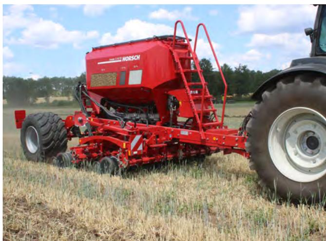
Sur l'Avatar de Horsch, la roulette de guidage en profondeur du soc se trouve directement sur le soc semoir.
