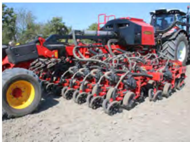
Semoirs monograines universels : Cette machine high-tech, qui permet de varier la densité de semis ou de travailler spécifiquement sur une partie de la surface, doit également être adaptée aux céréales, en plus du maïs et des betteraves sucrières.
