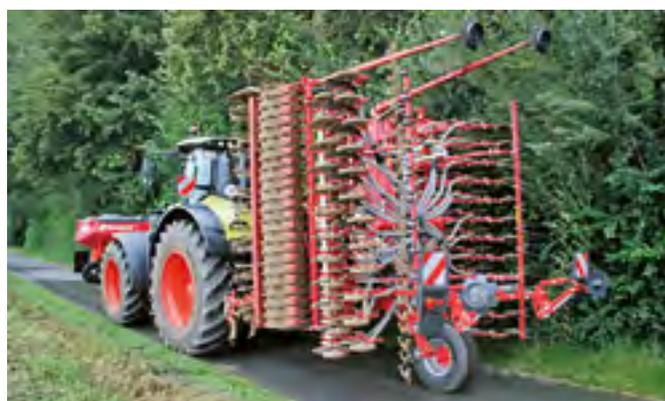
Contrôler la profondeur de travail de manière automatisée depuis le tracteur : C'est ce que permet la nouvelle génération de hermes rotatives Rotago F. Une roue d'appui supplémentaire à l'arrière de la combinaison d'outils assure un transport sur route sûr et légal (poids par essieu).
