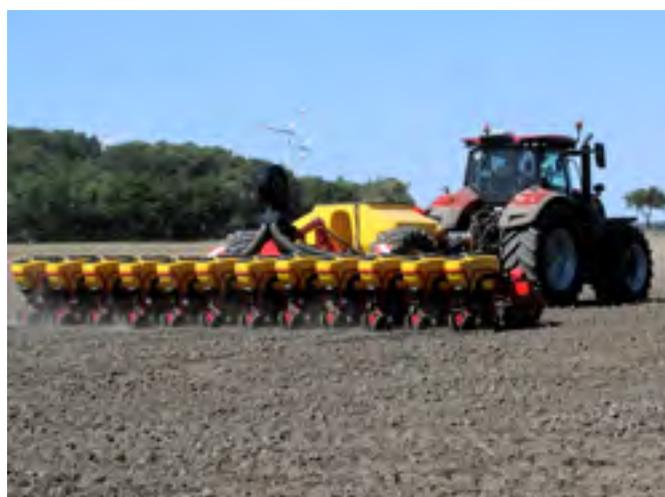
En option, un système d'engrais liquide : Le Tempo L, semoir monograinne éprouvé de 8 à 24 rangs, peut également placer avec précision l'engrais liquide.
