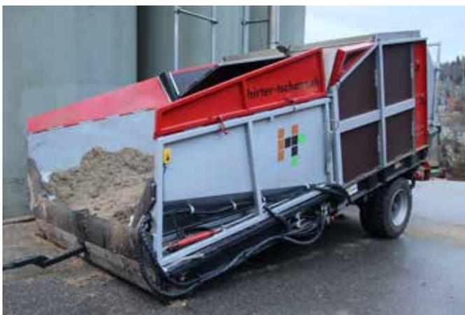
La combinaison du dispositif de dosage et de la soufflerie est adaptée à la route, et le moteur diesel sur la soufflerie permet un fonctionnement totalement autonome en ce qui concerne l'alimentation en énergie.
