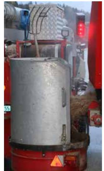
L'éjection du produit en vrac du dispositif de dosage se fait directement sur l'alimentation dans la soufflerie.
