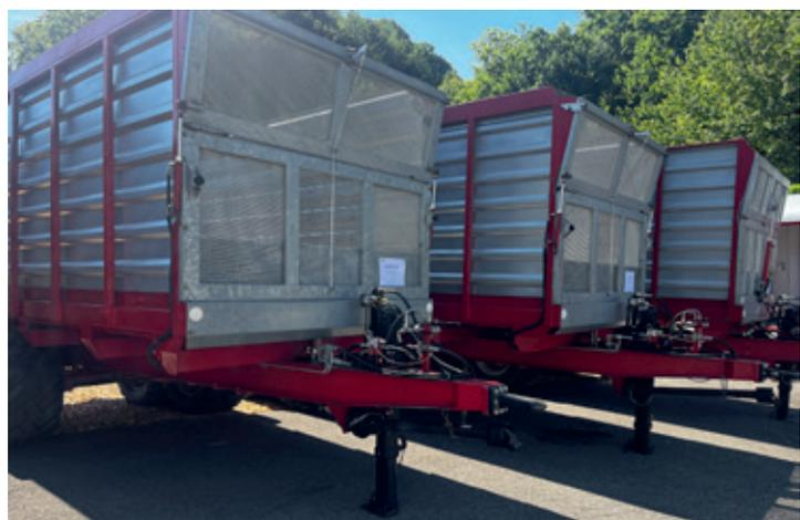
De l'équipement en machines : remorque de hachage et de dosage d'un volume de 22 m<sup>3</sup>.
