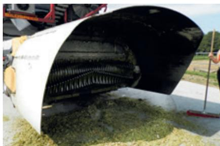
Le rotor de pressage et le tunnel métallique compriment le matériau. Il se forme ainsi des couches plutôt verticales qu'horizontales.
