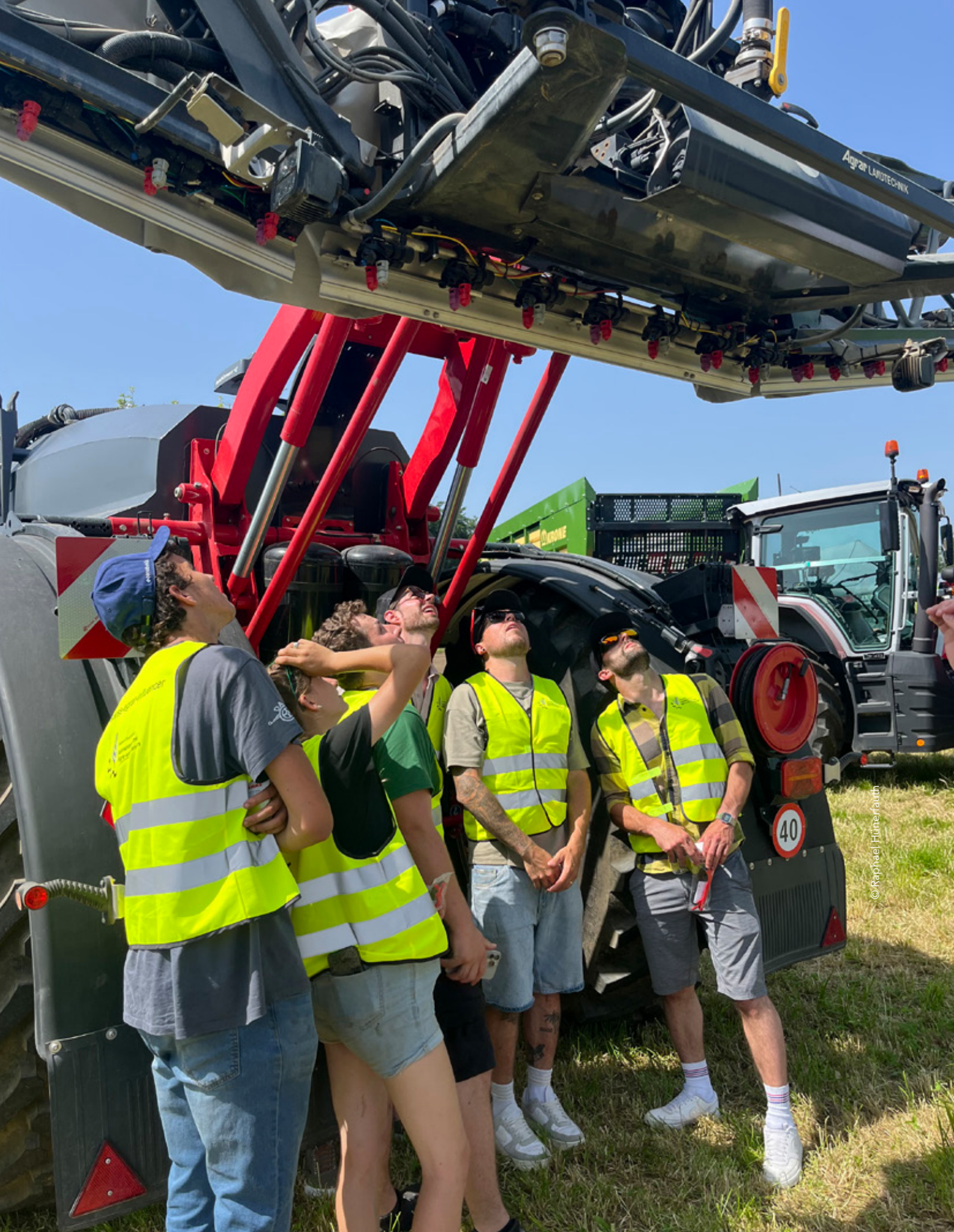
Vue vers le haut sur le guidage de la rampe de pulvérisation du pulvérisateur Horsch Leeb GS.
