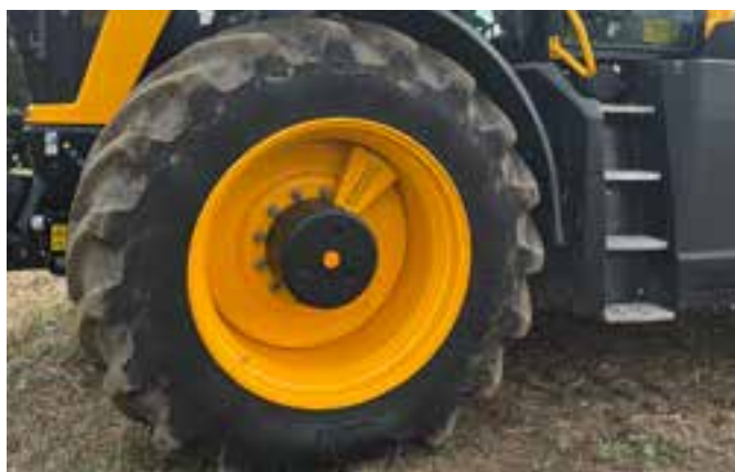
Une nouveauté est le système de régulation de la pression des pneus intégré en usine sous forme de système à conduit unique. Deux compresseurs entraînés par courroie trapézoïdale fournissent l'air. L'air aspiré est refroidi et filtré.
