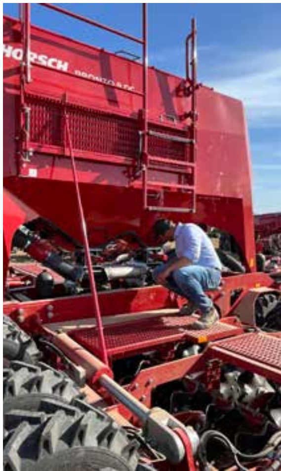
L'accès facile au rotor permet un changement même lorsque la trémie de semences est pleine, sans perte.
