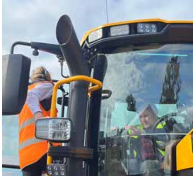
L'éclairage LED permet d'atteindre un maximum de 48 000 lm et un éclairage jusqu'à 360°.
