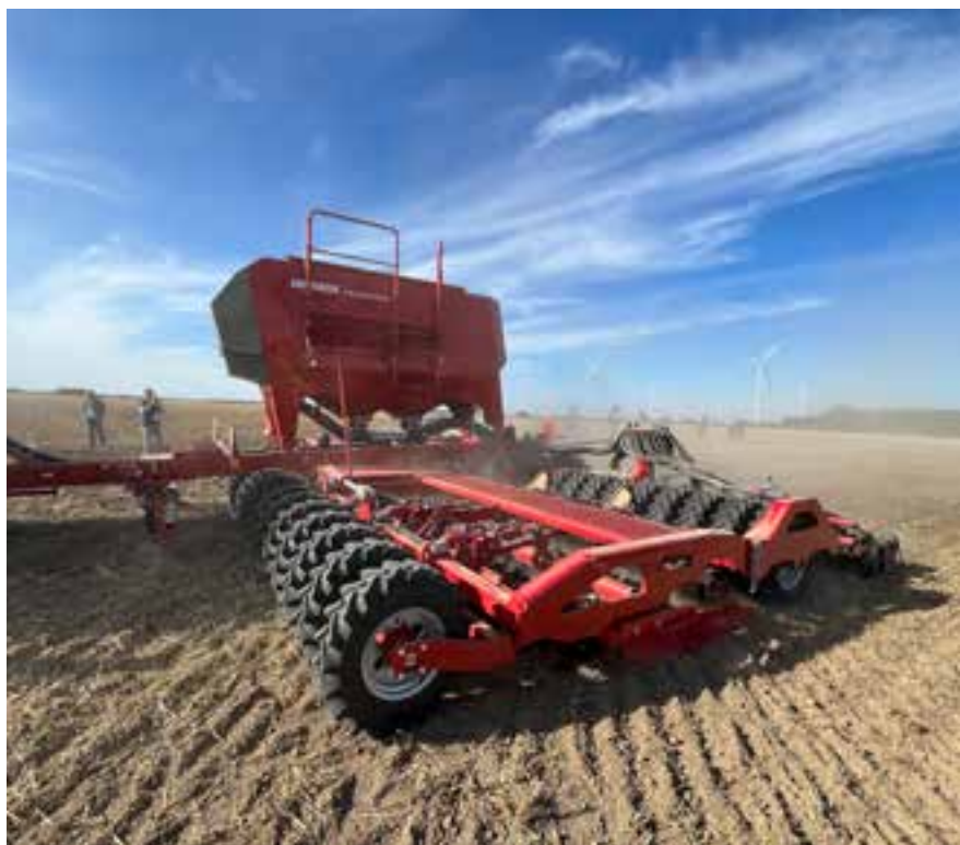
Le système à double réservoir G&F permet une application simultanée sur un horizon.
