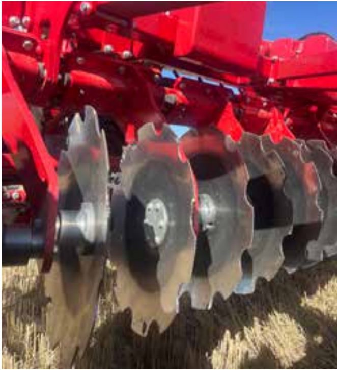
Les disques dentés d'un diamètre de 62 cm permettent un mélange intensif des matériaux visqueux.
