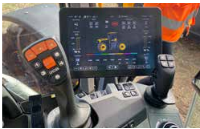
Le concept de commande iCON propose des écrans tactiles configurables et permet d'ajouter un moniteur supplémentaire.
